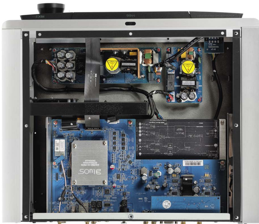
Moduł BluOS umieszczono w metalowym ekranie. Impulsowe zasilacze ulokowano w przedniej części obudowy.
